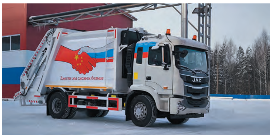
Рис. 2. Мусоровоз установлен на шасси JAC N200
